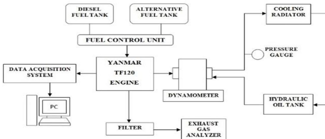
**Fig. 1:** YANMAR TF120 engine diagram
